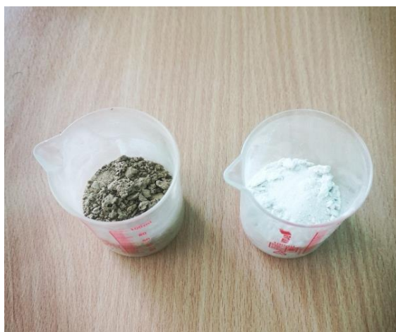
3 pav. Nufiltruoti ir išdžiovinti žemės ir gipso mėginiai.
